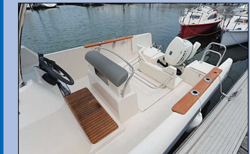
La petite plateforme de pilotage dispose d'un revêtement en teck. La cabine qui fait office de vaste rangement est accessible en soulevant l'assise placée devant la console.
