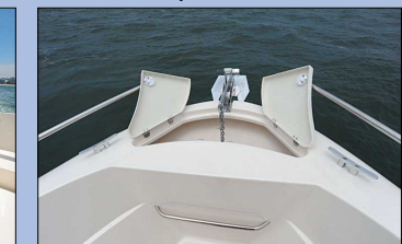
L'équipement pêche comprend quatre porte-cannes dans les plats-bords. La baille s'ouvre en deux parties et peut recevoir un guindeau électrique en option.
