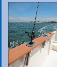
L'équipement pêche comprend quatre porte-cannes dans les plats-bords. La baille s'ouvre en deux parties et peut recevoir un guindeau électrique en option.
